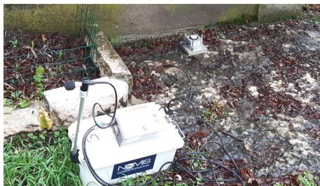
Station de capteurs de vibrations et de sons à Chanoz
