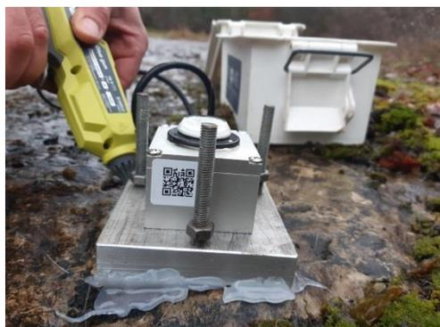
Pose du capteur de vibrations aux Brosses
